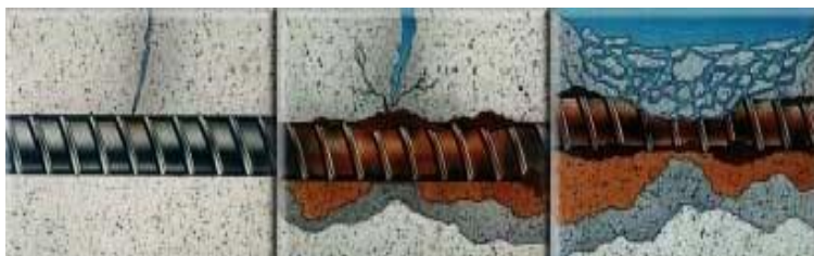
Nedbrytningsförlopp i betong med Armeringskorrosion, Rost- & Frostsprängningar
